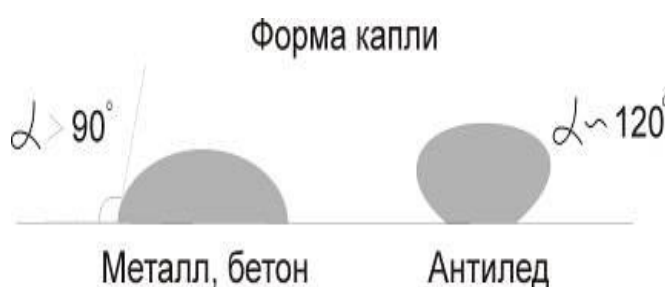
Рис.18. Вид формы капли необработанной и обработанной составом Силокор «Антилёд» поверхности
