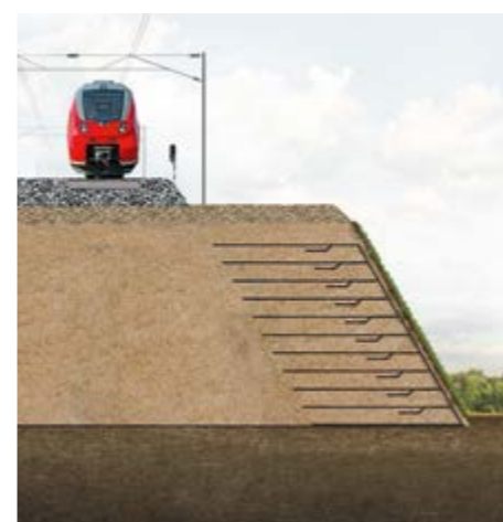
Подпорные стены/откосы повышенной крутизны
