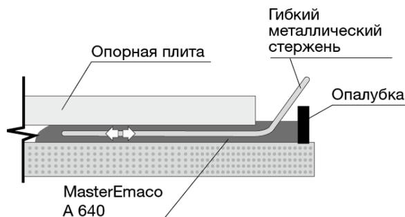
**Рисунок 3. Технология установки оборудования и металлоконструкций.**
